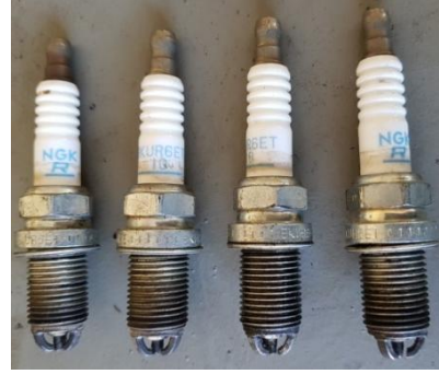
Şekil 3b. Deneylerde kullanılan üç tırnaklı bujiler
