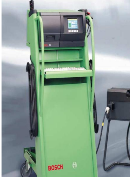
Şekil 1.Egzoz gaz emisyonları ölçüm cihazı.
